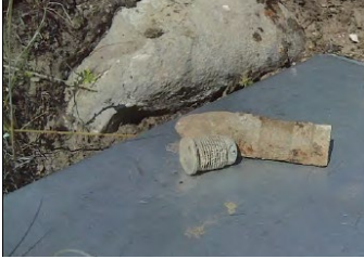
Fragmento de 37 mm y un fusible de percusión de base Mark I (37 mm)
